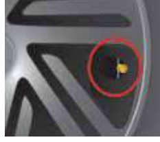
Posición incorrecta de la válvula: por debajo de la circunferencia.
